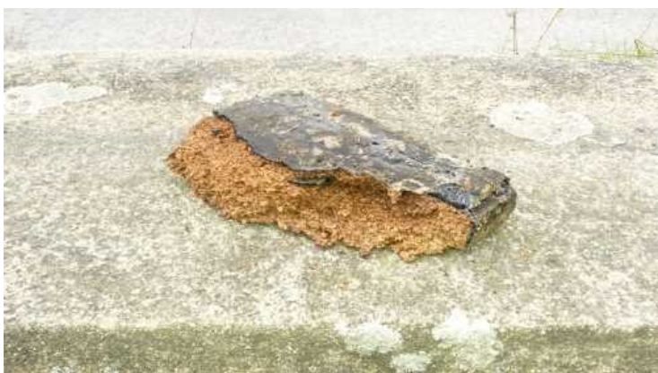
Hmota, na které je uložena nosná konstrukce
